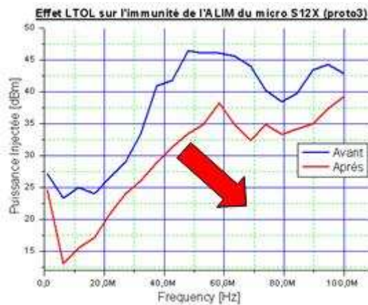
Figure 1 - Evolution de l'immunité d'un composant après un test de vieillissement standard
